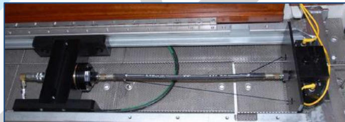
ΔL con encoder a filo per tubi DN > 8 mm ΔL hoses DN > 8 mm by encoder system
