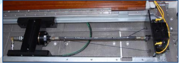
编码器系统旁软管长度变化 公称直径 > 8 mm \Delta L hoses DN > 8 mm by encoder system
