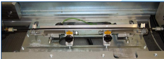
ΔL con sistema laser per tubi DN ≤ 10 mm ΔL hoses DN ≤ 10 mm by laser system
